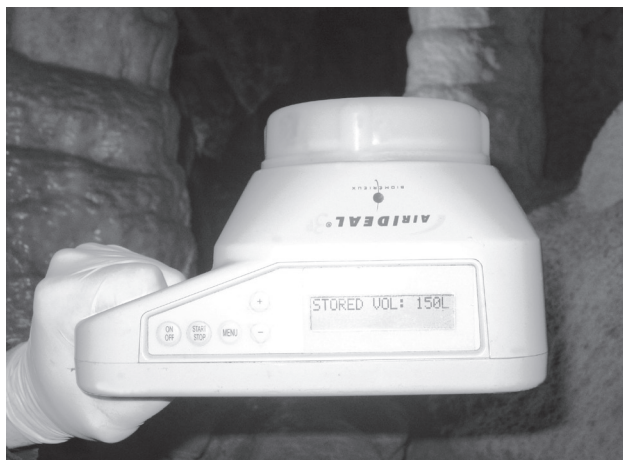
Rys. 2. Wygląd aparatu podczas badań mikologicznych powietrza w jaskini Driny (Słowacja), próbnik ustawiono na pobór 150 litrów powietrza (fot. R. Ogórek)
